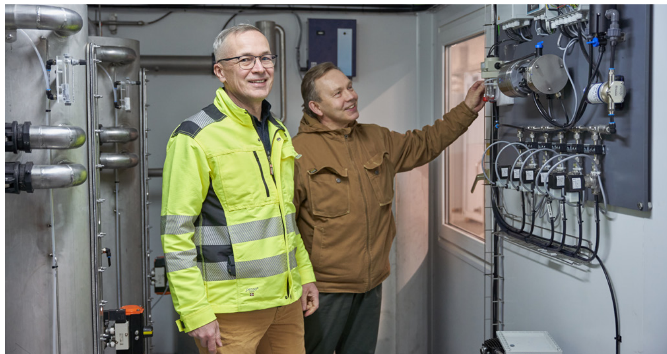
Tartu Ülikooli keskkonnakeemia kaasprofessor Taavo Tenno ja AS-i Tartu Veevärk reoveepuhasti juhataja Kaido Põhako vaatavad üle seadet, millega katsetatakse puhasti väljavoolul püsivate saasteainete eemaldamist reoveest.
